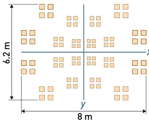
Schema di rilevamento a livello del suolo per h montaggio = 2,5 m
