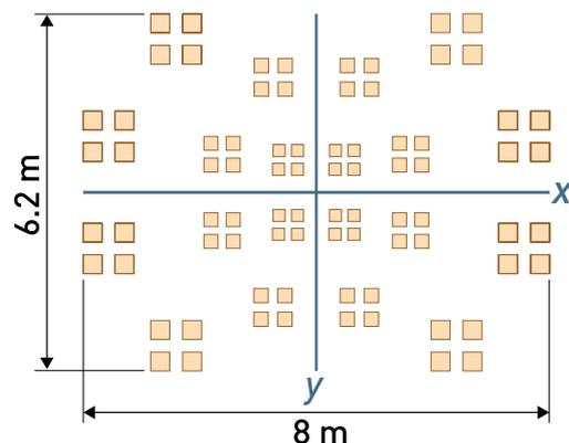
Schema di rilevamento a livello del suolo per h montaggio = 2,5 m
