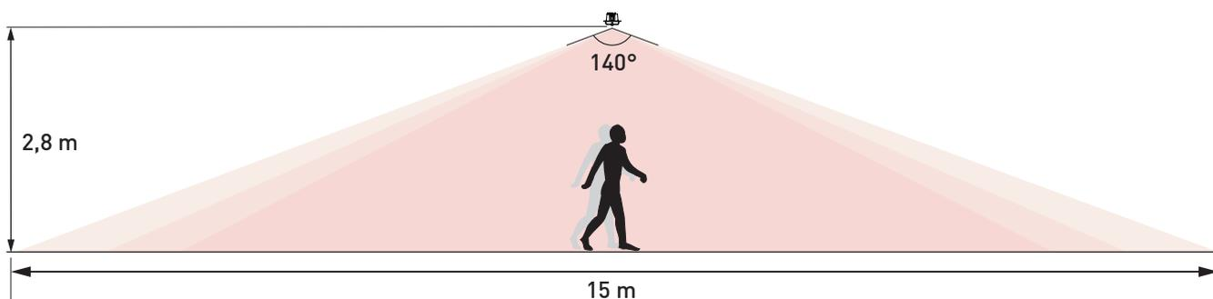
Du fait de la technologie de détection (PIR), le déplacement d'une personne directement en direction du centre du capteur réduit la finesse de la détection. Le point de détection est affecté par l'environnement, la vitesse de déplacement, le type de vêtements ou la température de l'air. Il n'est donc pas possible de garantir une zone de détection lorsque que le déplacement d'une personne se fait directement vers le capteur.
