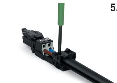
5. Pressez vers le bas l'attache du serre-câble avec un tournevis 2,5 mm en alternant des deux côtés.
