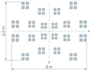
Patrón de detección a nivel del suelo para una altura de montaje de 2,5 m
