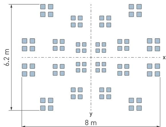
Schema di rilevamento a livello del suolo per altezza di montaggio = 2,5 m
