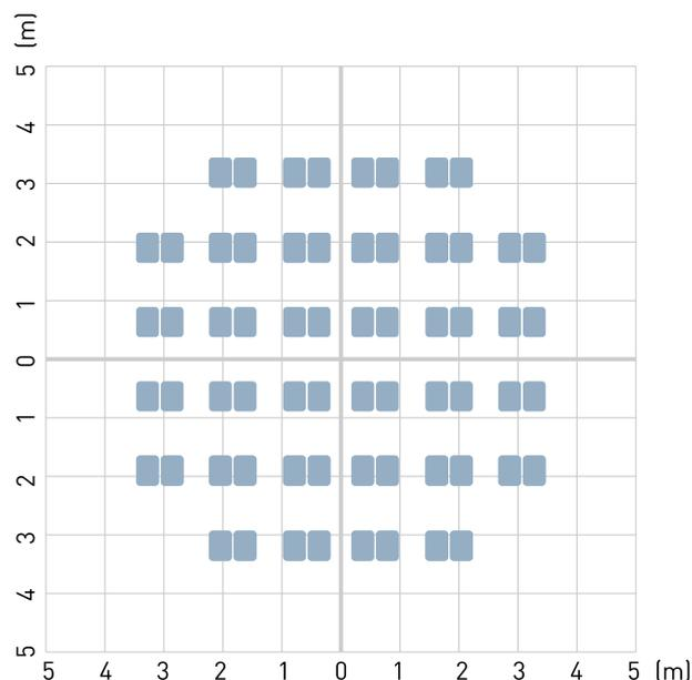
Patrón de detección a nivel del suelo para una altura de montaje de 2,5 m
