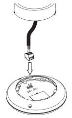
4. Ricollegare il ricevitore al supporto (allineare, inserire e ruotare). Alimentare la rete DALI.
