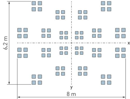
Patrón de detección a la altura del suelo para una altura de montaje de 2,5 m
