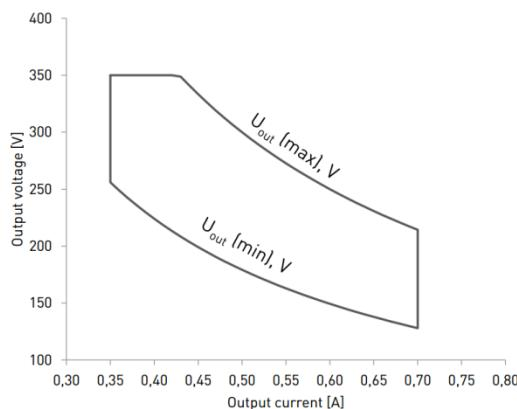
Примечание: Регулировка яркости в диапазоне 1 – 100% возможно на всём рабочем диапазоне.
