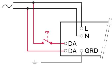
Схема подключения выключателя драйвера
